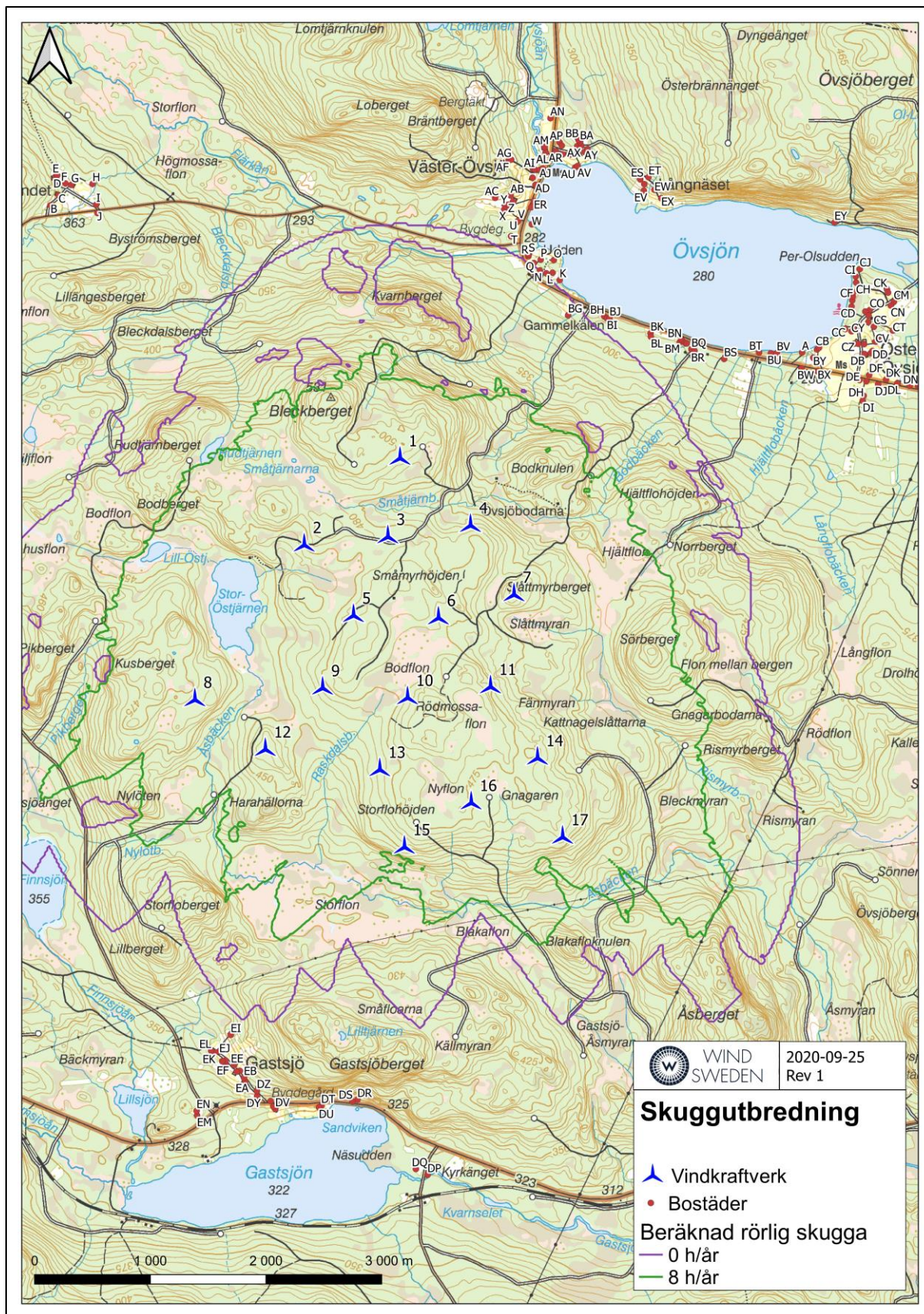
Figur 36. Utbredning av rörliga skuggor runt ansökt utformning.
