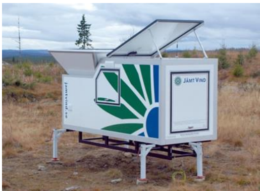
Figur 20. Jämt Vind mäter vinden i sina projekt med en Sodar.
